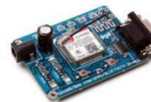
Fig. 4 GSM Module
